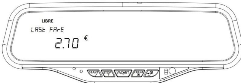
La mesure de mètres est montrée sur l'écran inférieur du taximètre comme ci-dessous quand on appuie encore une fois sur la touche
